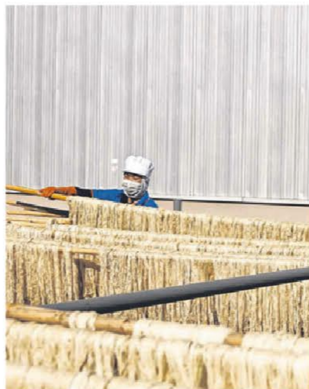
Nextevo从黄梨叶萃取纤维，去除胶质，烘干后纺成纱线。
